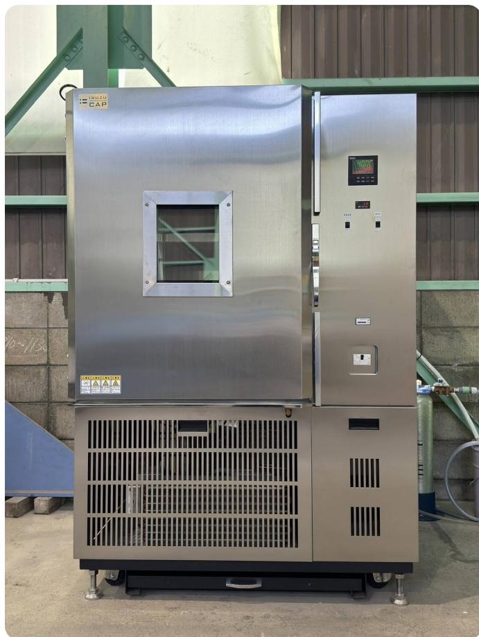
水分浸透速度係数試験に使用する温湿度管理機
