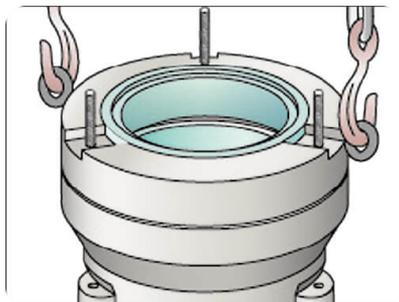
①斜壁に調整ボルトを取り付けて、調整リングをセットします。調整リング下部にゴムリングをセットするため、充填材等の必要はありません。
