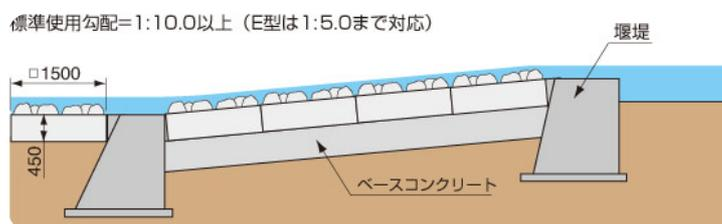
※必要に応じて、敷モルタルを使用して下さい。※ベースコンクリートを打設しない場合は、河床の不陸を均し、必ず吸出防止材を使用して下さい。
